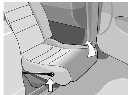
De requerirse, ajuste el asiento a una posición de giro óptima. Desbloquee el retén de giro tirando de la palanca hacia arriba, pero no demasiado fuerte. Para replegar el asiento, deslice el asiento. Suelte el retén de giro y eleve los pies. ¡Atención! Tenga cuidado con la cabeza. Repliegue el asiento hasta que quede inmovilizado.
