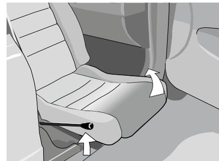
Regolare il sedile (schienale ecc.), se necessario, nella posizione ottimale per la rotazione verso l'interno. Alzare con delicatezza la leva di blocco rotazione. Girare in dentro spingendo il sedile. Rilasciare la leva. Fare attenzione al capo e ai piedi del disabile! Ruotare il sedile fino a quando si bloccherà nella posizione interna massima.
