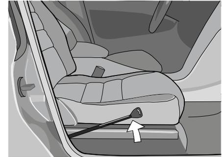
1. Justera sätet i längdsled till optimalt läge, så att Turnoutens inre hörn ej tar emot i mittkonsolen vid utvridning. Frigör vridspärren genom att lyfta uppåt.
