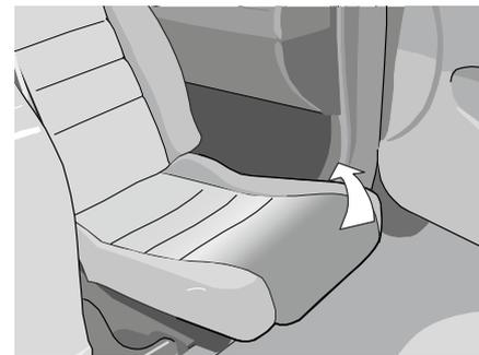
De requerirse, ajuste el asiento manualmente a una posición de giro óptima. El asiento se desplegará mientras se mantenga pulsado el botón derecho del mando manual. ¡Atención! Tenga cuidado con la cabeza. Al llegar a su posición final, el movimiento eléctrico de giro se detendrá automáticamente.
