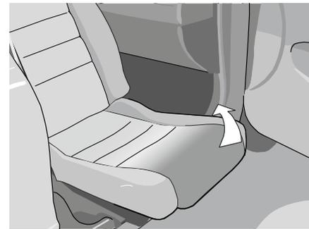
Réglez au besoin le siège manuellement dans la position de rotation optimale. Le siège est tourné vers l'intérieur tant que le bouton de droite de la commande manuelle reste enfoncé. Attention à la tête de l'utilisateur ! La rotation électrique s'arrête automatiquement quand le siège est complètement tourné à l'intérieur de la voiture.
