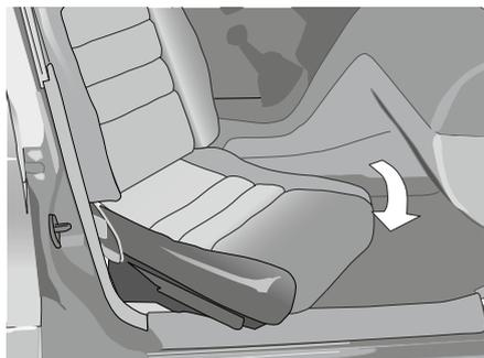
2. Il sedile ruoterà verso l'esterno fin quando verrà spinto il tasto sinistro del comando manuale. Raggiunta la posizione esterna massima, il sedile si fermerà automaticamente.
