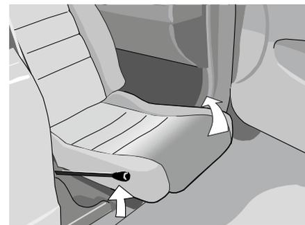
Justera sätet vid behov till optimalt vridläge. Frigör vridspärren genom att lyfta spaken uppåt. Vrid in genom att skjuta på sätet.
