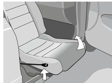
Réglez au besoin le siège dans la position de rotation optimale. Libérez le verrou de rotation en soulevant le levier vers le haut. Ne forcez pas trop. Tournez vers l'intérieur en poussant le siège. Relâchez le verrou de rotation. Soulevez les pieds pour les rentrer. Attention à la tête de l'utilisateur ! Tournez le siège jusqu'à ce qu'il se bloque.
