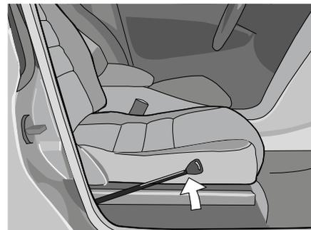
1. Richten Sie den Sitz optimal in Längsrichtung aus, so dass die innere Ecke des Turnouts beim Herausschwenken nicht gegen die Mittelkonsole stößt. Lösen Sie die Schwenkverriegelung, indem Sie den Hebel nach oben ziehen.
