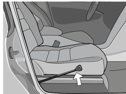
1. Regolare il sedile longitudinalmente per ottimizzarne lo spazio nella rotazione. Alzare la leva di blocco rotazione.
