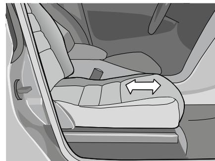
1. Ajuste el asiento longitudinal-mente hasta una posición óptima, de forma que la esquina interior de Turnout no choque contra la con-sola central en el despliegue.
