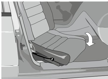
2. Vrid utåt genom att greppa i sätet, ej i vridspärren. Spärren skall inte hållas uppe under vridningen. När vridningen fullföljts spärras sätet automatiskt.
