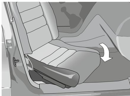
2. Der Sitz schwenkt so lange nach außen, wie die linke Taste an der Handbedienung gedrückt gehalten wird. Bei Erreichen der Endposition wird der Schwenkvorgang automatisch gestoppt.
