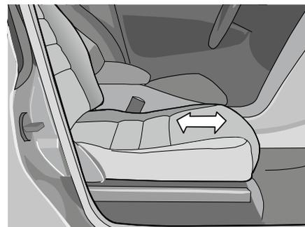
1. Réglez manuellement le siège en longueur pour que le coin intérieur de Turnout ne heurte pas la console centrale lors de la rotation vers l'extérieur.
