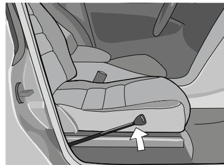
1. Réglez le siège en longueur pour que le coin intérieur de Turnout ne heurte pas la console centrale lors de la rotation vers l'extérieur. Libérez le verrou de rotation en le soulevant vers le haut.
