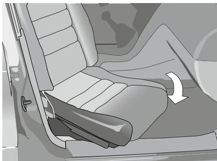
2. Sätet vrids utåt så länge som handkontrollens vänstra knapp är nedtryckt. Vid slutposition stannar utvridningen automatiskt.
