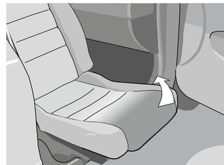
Regolare il sedile (schienale ecc.), se necessario, nella posizione ottimale per la rotazione verso l'interno. Il sedile ruoterà in dentro fin quando verrà spinto il tasto destro del comando manuale. Raggiunta la massima posizione interna, il sedile si fermerà automaticamente.
