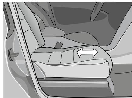
1. Richten Sie den Sitz optimal in Längsrichtung aus, so dass die innere Ecke des Turnouts beim Herausdrehen nicht gegen die Mittelkonsole stößt.
