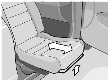
3. Se necessario, è possibile portare il sedile ancora più in fuori tirando la leva che ne regola il movimento longitudinale.
