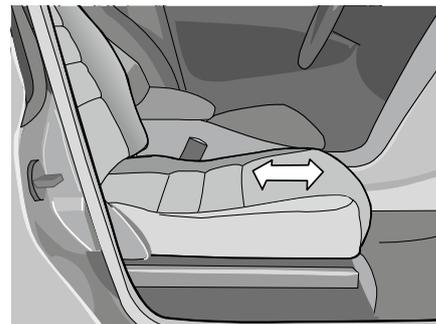
1. Justera sätet i längdsled manuellt till optimalt vridläge så att Turnoutens inre hörn ej tar emot i mittkonsolen vid utvridning.
