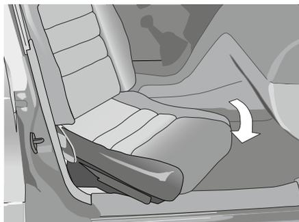
2. Le siège est tourné vers l'extérieur tant que le bouton de gauche de la commande manuelle reste enfoncé. La rotation vers l'extérieur s'arrête automatiquement en position finale.
