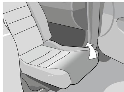
Stellen Sie den Sitz bei Bedarf manuell in die optimale Schwenkposition. Der Sitz schwenkt so lange nach innen, wie die rechte Taste an der Handbedienung gedrückt gehalten wird. Wenn der Sitz vollständig in das Fahrzeug hineingeschwenkt ist, hält die Bewegung automatisch an.
