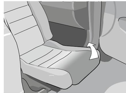
Justera sätet vid behov manuellt till optimalt vridläge. Sätet vrids inåt så länge som handkontrollens högra knapp är nedtryckt. Då sätet är helt invriden i bilen stannar den elektriska vridningen automatiskt.
