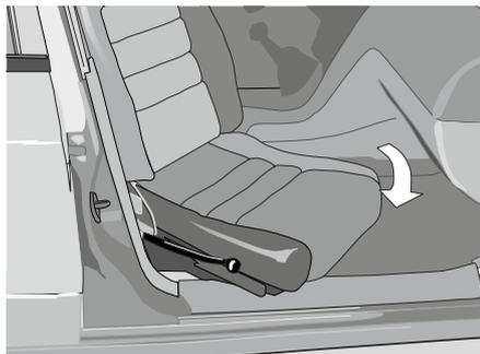
2. Se necessario, è possibile portare il sedile ancora più in fuori tirando la leva che ne regola il movimento longitudinale.
