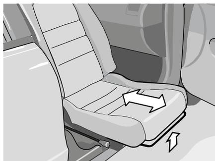
3. Si nécessaire, le siège peut être poussé vers l'extérieur en libérant le verrou de réglage en longueur.
