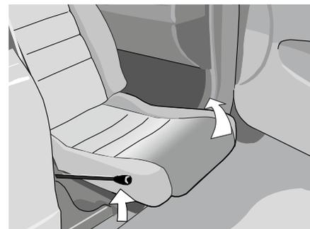
Stellen Sie den Sitz bei Bedarf in die optimale Schwenkposition. Ziehen Sie den Hebel für die Schwenkentriegelung nach oben. Schwenken Sie den Sitz durch Schieben ins Auto.
