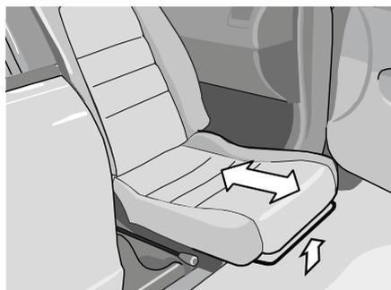
3. Bei Bedarf kann der Sitz nach außen geschoben werden, indem man die Verriegelung der Längsjustierung löst.
