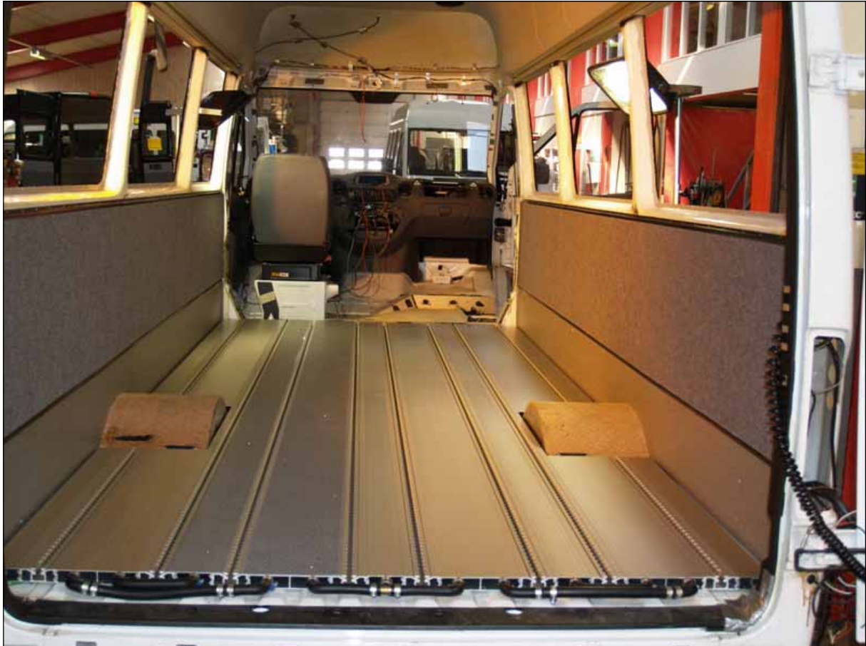
Le plancher SpaceFloor correctement installé
