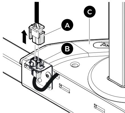
1 Retire el conector (A) de la toma (B) de la pata (C).
