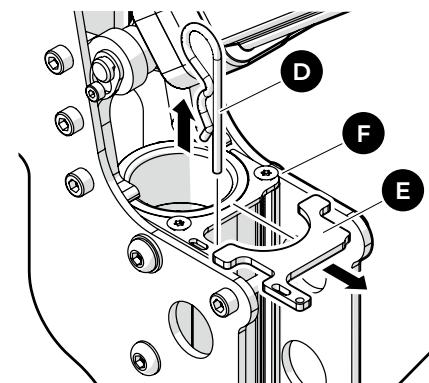
2 Entfernen Sie den Sicherungsstift (D) und die Sicherungsplatte (E) von der Hebevorrichtung (F).
