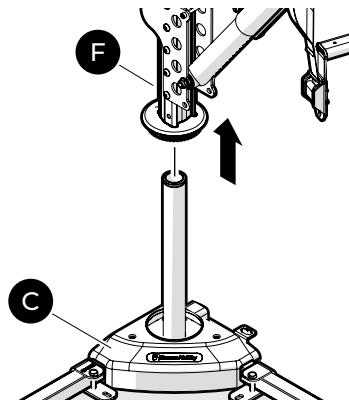
3 Ziehen Sie die Hebevorrichtung (F) zum Abnehmen gerade nach oben aus dem Sockel (C).
