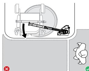
Por razones de seguridad, al utilizar la grúa, asegúrese de mantenerse en la zona de seguridad operativa y no situarse en la dirección del brazo de elevación de la grúa.
