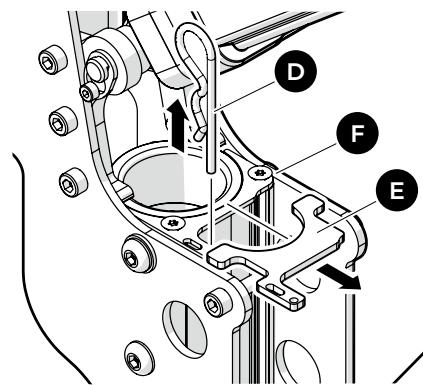
2 Retire el pasador de bloqueo (D) y la placa de bloqueo (E) de la grúa (F).
