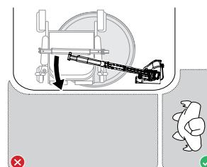
Achten Sie aus Sicherheitsgründen beim Bedienen der Hebevorrichtung darauf, dass Sie in der Sicherheitszone und nicht in der Bewegungsrichtung des Hebearms stehen.
