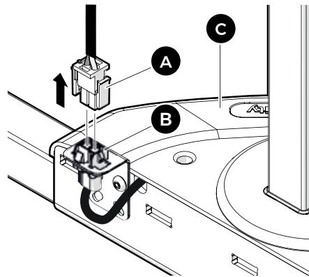
1 Ziehen Sie den Stecker (A) aus der Buchse (B) am Sockel (C).
