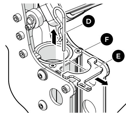
**2** Rimuovere il perno di bloccaggio (D) e la piastra di bloccaggio (E) dal sollevatore (F).
